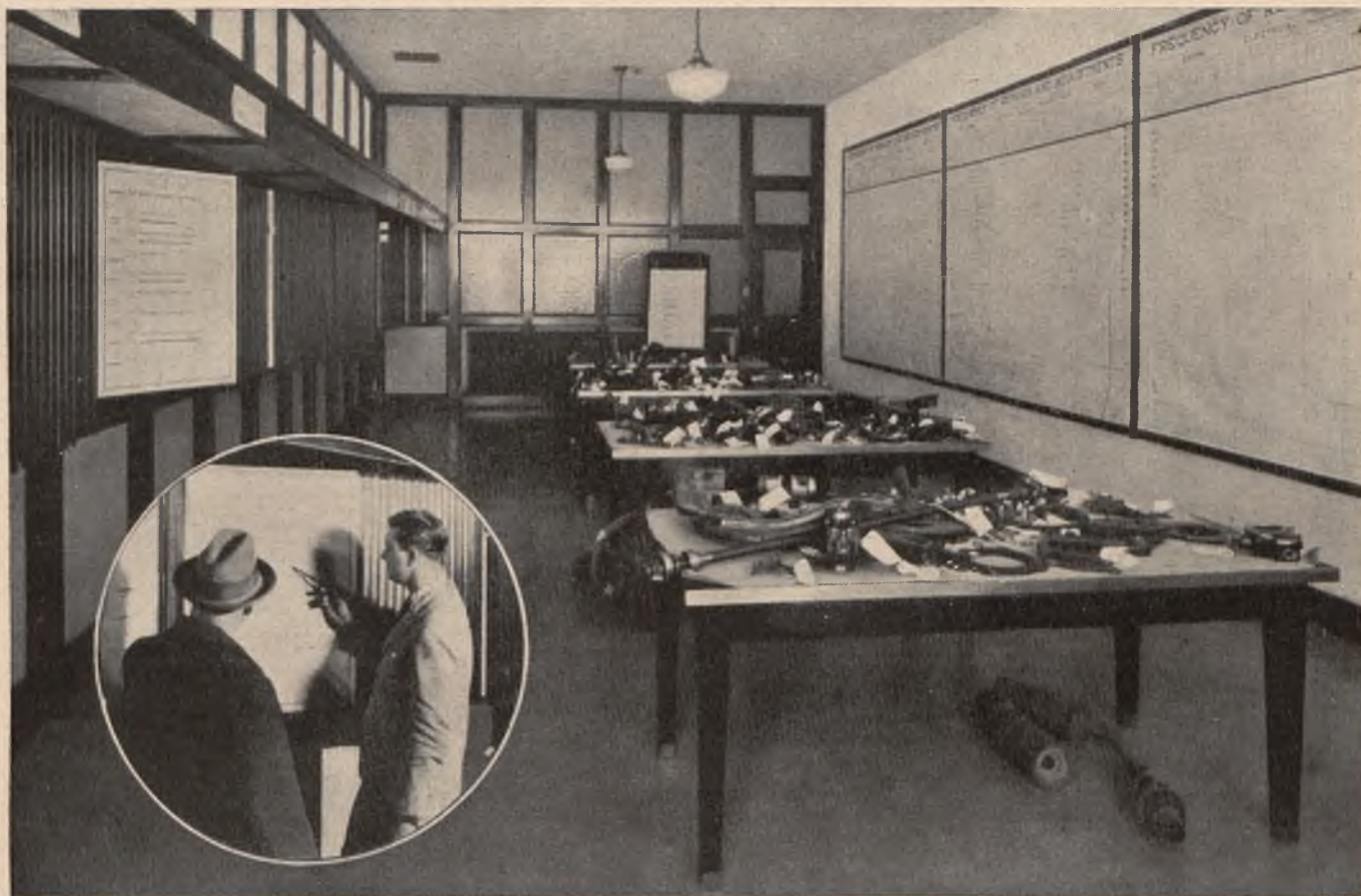
Wykresy statystyczne, jako rezultat badań, przeprowadzonych na terenie doświadczalnym. Na stołach znajdują się części zepsute z zaznaczeniem kiedy nastąpiło zepsucie i z jakiego samochodu zepsuta część pochodzi.
