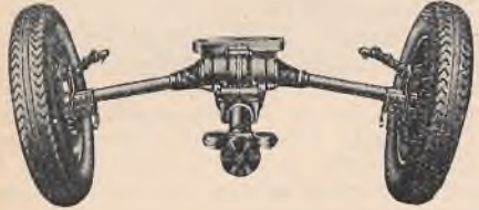
Łamana oś tylna znajduje coraz szersze zastosowanie.
