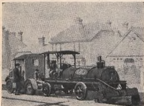
Rozlewaczka typu „Omnia” dla smoły, asfaltu i emulsji. Pojemność 2 tys. litrów.
