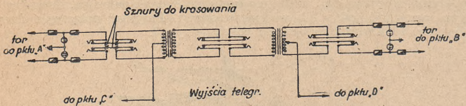
Rys. 6. Włączenie przenośników w układzie tranzytowym
