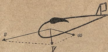
Szkic 2. Szybowiec leci w wietrze poziomym w m/sek. z szybkością V względem ziemi.
