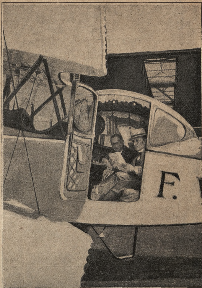
Płatowiec niemiecki D. F. W. przerobiony z wojennego na pasażerski, widać wyraźnie pękata nadbudowę kadłuba w celu użytkowania kabiny.
