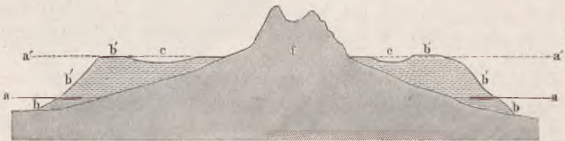
a a Ursprüngliches Meeresniveau. b b Ursprüngliches Küsterriff. a' a' Jeziges Meeresniveau. b' b' Jeziges Barrierriff. c c Lagunencanal. f Centraler Inselkelsen.
