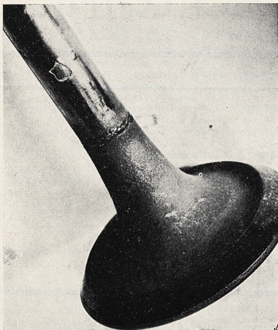
Rys. 1. Zendrowanie się azotowanej powierzchni trzonka w zaworze wydechowym.
