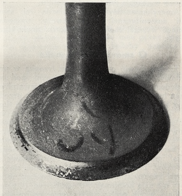
Rys. 12. Zawór po 200 godzinach pracy. Widać, że tylko górna część przyłgni przylega do siodła.
