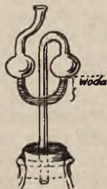
Rurka fermentacyjna ze zgiętej rurki szklanej najprostszej konstrukcji.
