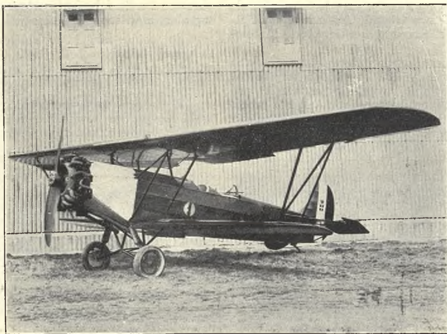
Samolot RO. 1 z podwoziem oleo - pneumatycznym. Aeroplano RO. 1 con carrello oleo - elastico.
