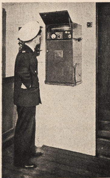
Echometr dla mierzenia głębokości morza
