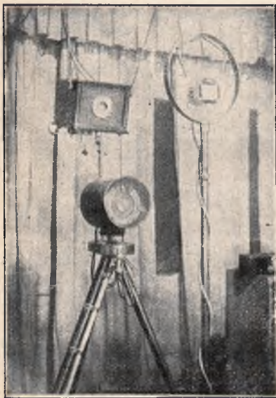
Rys. 1. Mikrofony w studiu P. R. w Warszawie. U góry z lewej strony wisi mikrofon elektrostatyczny „Western Electric Co”, obok niego na wysokim postumencie zawieszony mikrofon węglowy „Reiss-Marconi” u dołu — magnetofon Marconiego.
