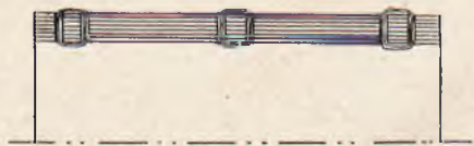
Rys. 4. Przekrój walca zwiniełego z blachy. Na rys. widać trzy punkty zeszcicia.
