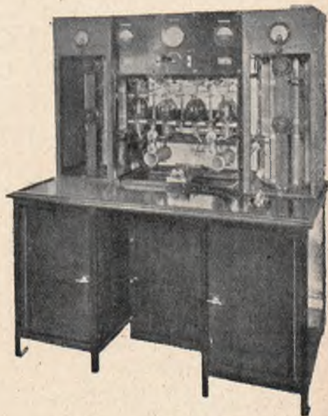
Rys. 2. Widok zewnętrzny automatycznego aparatu nadawczego latarni radiowej typu WB2 Marconiego.
