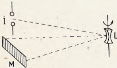
Rys. 1a. Iskra (i), odbita w lustrze wirującym (L) daje pasmo ujawniające drgający charakter wyładowania. (p. rys. 1b.)
