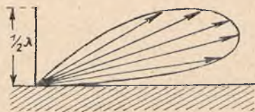
Rys. 2. Krzywa jak na rys. 1, tylko z uwzględnieniem przewodnictwa ziemi.
