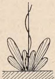
Rys. 3. Promieniowanie w płaszczyźnie poziomej anten różnego typu.
