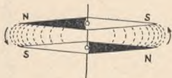
Rys. 1. Astatyczny układ igieł magnetycznych.
