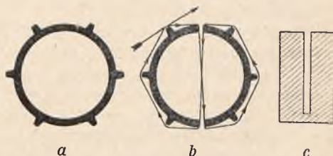
Rys. 6. Ósemkowe wykonanie cewki systemem t. zw. minless coil.
