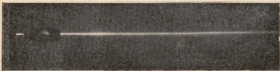
Rys. 1. Zdjęcie fotograficzne promienia katodowego, wytworzonego przez rurkę braunowską.
