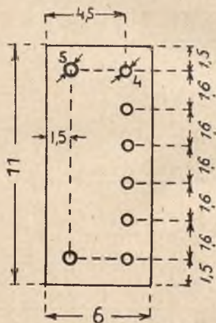
Rys. 4. Płytki rozdzielcze transformatora; wymiary dla tr. Nr. 7.
