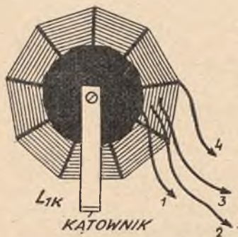
Rys. 4. Autotransformator antenowo-siatkowy ( L_1 ) na fale Kr.
