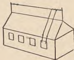
Rys. 2. Przykład praktycznego wykonania anteny przeciwzakłócenkowej z podwójnem doprowadzeniem.
