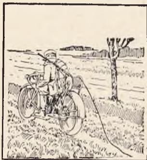
Ryc. 4. Budowa linii polowej z motocykla.
