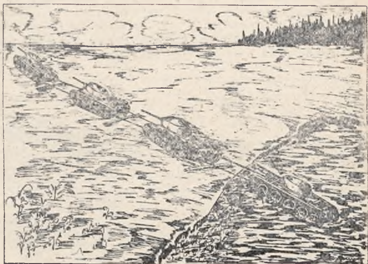
Rys. 3. Wykorzystanie trzech czołgów przy ewakuacji czołga z średniego błota w warunkach zimowych.
