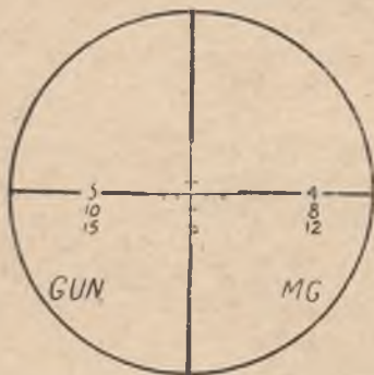
Rys. 5. Pole widzenia angielskiego celownika teleskopowego armaty 40 mm. z k.m. BSA. (z nieruchomym skrzyżowaniem celowniczym).
