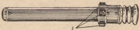
Rys. 4. Ogólny widok angielskiego celownika teleskopowego (z nieruchomym skrzyżowaniem celowniczym) czołgowej armaty 40 mm, sprężonej z k.m. BSA.
