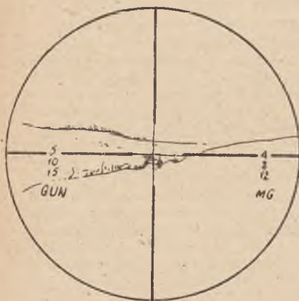
Rys. 6. Pole widzenia po wycelowaniu celownikiem armatnim 10.
