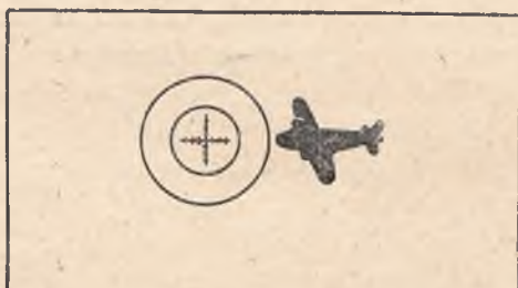
Rys. 6. Położenie sylwetki samolotu i siatki celownika do chwili włączenia lampki elektrycznej
