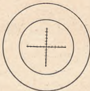
Rys. 5. Siatka celownika kalimatorowego K.8T
