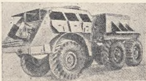
Rys. 3. Opancerzony ciągnik holujący z przyczepą (M-26), produkcji amerykańskiej
