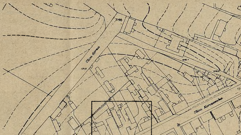
Rys. 3. Przykład planu sytuacyjno-wysokościowego 1:2000. Wykazuje wszystkie dane pierworysu, lecz bez konieczności wykazywania numerów działek wg. rejestru pomiarowego. Plan ten zazwyczaj służy jako podkład do szczegółowych planów zabudowania.
