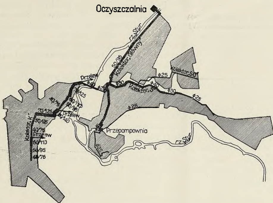
Rys. 7. Kanalizacja m. Łucka— Projekt generalny. — Projekt wykonało w r. 1936 Biuro Pro- jektów Wod. Kan. przy Komis- ji Reg. Pl. Zab. Wołynia w Łucku.
