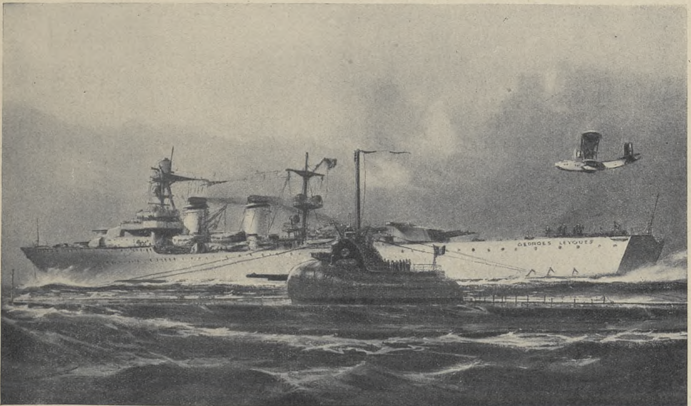
Krażownik „Georges-Leygues“ w asyście łodzi podwodnej „Le Sorcouf“ i dużego hydroplanu. Fojemność krążownika 7600 ton. Długość krążownika 179 m. Szerokość krążownika 17 m. 48. Siła 88.000 HP. Szybkość 32,5 węzły. Uzbrojenie: Armat 152 mm — 9. Armat 90 mm przeciwlotniczych — 9. Karabinów maszynowych — 8. Urządzeń torpedowych 550 mm — 4. Katapulta — 1.
