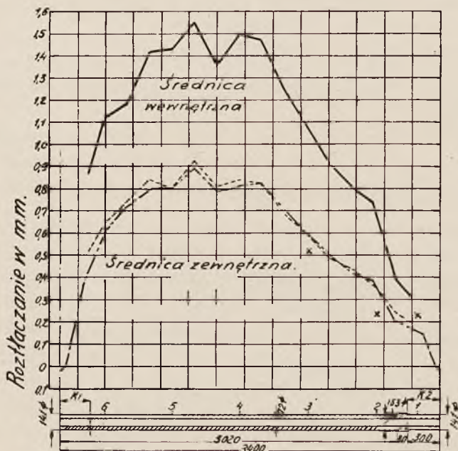
Próbna rura №5 (stal węglista St. C.45,61 termicznie uszlachet.)
