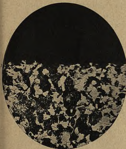
Fot. 3. Struktura próbki 1 po wyżarzeniu przy temp. 780° C przez 30' (powiększenie \times 170 ).
