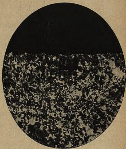
Fot. 2. Struktura normalna na powierzchni przewodu (powiększenie \times 170 )
