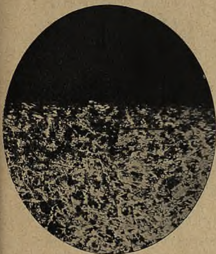
Fot. 1. Deformacja na powierzchni przewodu (powiększenia \times 170 ).
