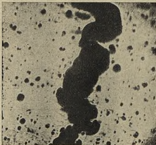
Rys. 5. (X 100) Mikrofotografja wyjścia zażuzleń w przekroju poprzecznym do walcowania.
