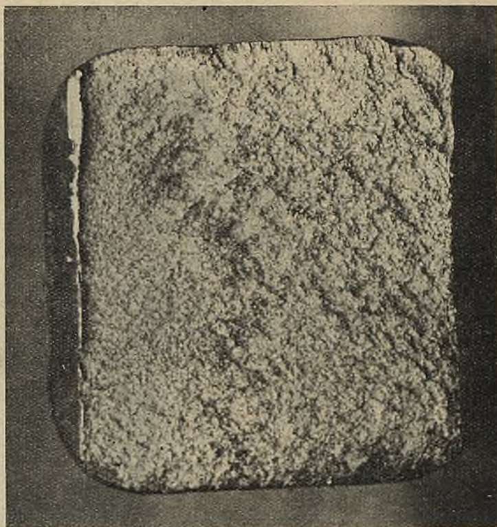
Rys. 15. Prawidłowy przełom bloczka.
