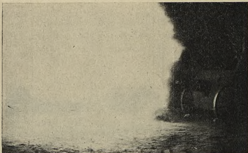
Rys. 9 (fotografja) Wielkość i intensywność płomienia wylotowego po strzale w nocy prochem BG 5 bez soli przeciwbłyskowej.
