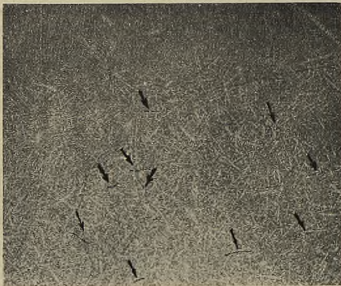
Fot. 1. ( \times 3 ) Płytkę poprzeczną trawioną roztworem kwasu solnego i siarkowego. Widać rysy wskazane strzałkami.
