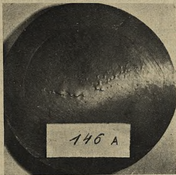
Fot. 17. Płytką zgiętą z materiału wadliwego, walcowanego równocześnie z materiałem, jak na fot. 18.
