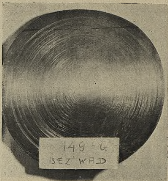
Fot. 18. Płytką zgięta z materiału dobrego, walcowanego równocześnie z materiałem, jak na fot. 17.
