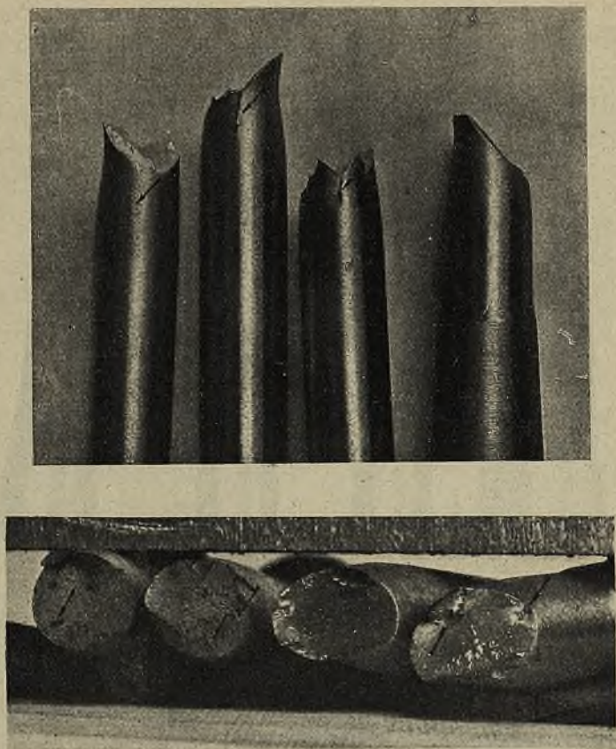
Fot. 4. (n. w.). Przełomy próbek, oraz widok walcowej części z rysami; próbki 2 i 5 z tabeli I.
