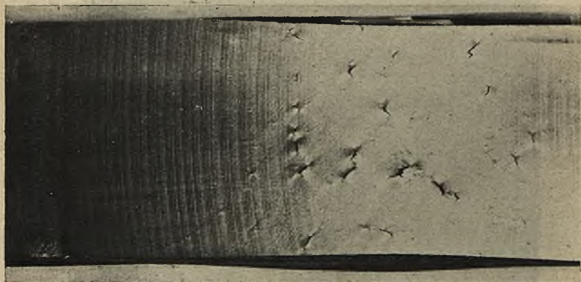
Fot. 16. Pasek 30 mm wycięty z płytki o grubości 22 mm po zgięciu.
