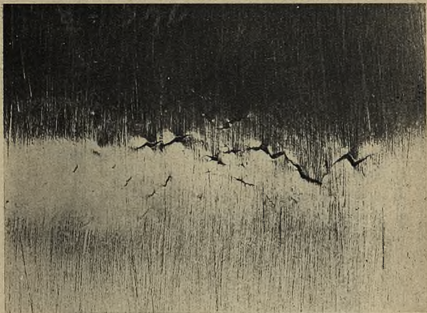
Fot. 10. Płytkę poprzeczną z rygla 100 \times 100 mm zgiętą po normalizującym wyżarzeniu. Widać rysy.
