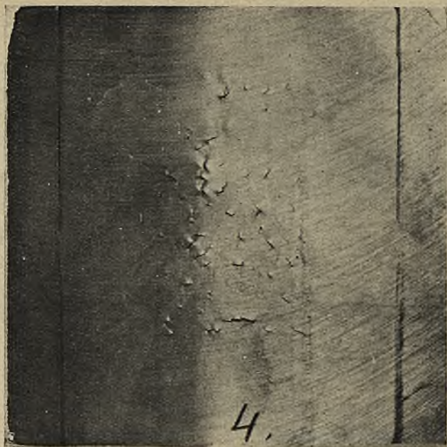
Fot. 15. Płytką zgiętą grubości 12,5 mm.
