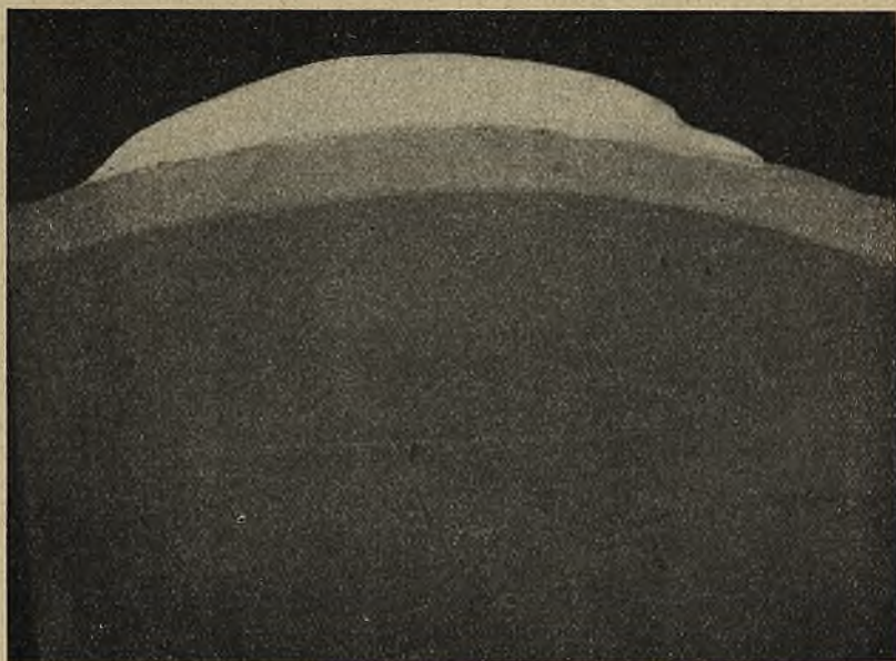
Rys. 12. (x 4) Przekrój poprzeczny części noska po trawieniu.
