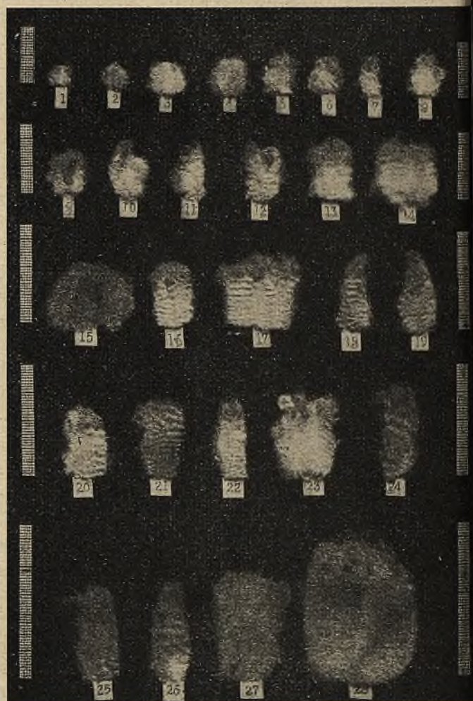
Rys. 1. Zdjęcie (1/2 normalnej wielkości) próbek wełny krajowej, pobranych bezpośrednio w fabryce, produkującej tkaniny wełniane. Wszystkie powyższe próbki pochodzą z 1 worka wełny. Po obu stronach skłala centymetrowa.
