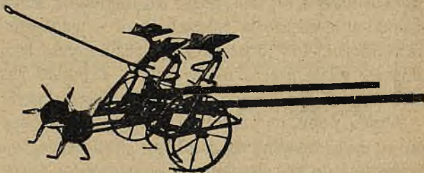
Rys. 6. Małe „wielokrotne“ narzędzie do uprawy okopowych. Konstrukcja pozwala na unoszenie radełek podczas pracy narzędzia jako znacznika. Odwrotnie — podczas obredlania gwiazdy znacznika zostają uniesione, zaś radełka opuszczone.
