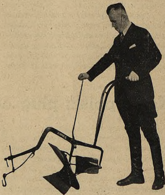
Sposób uruchomienia dźwigni przy zawracaniu pługa i równoczesnym obracaniu korpusu roboczego.
