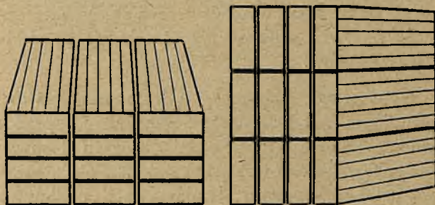
Rys. 6. Z lewej: Nieprawidłowy sposób ustawienia skrzynek napełnionych owocami z przybitymi przykrywkami. Z prawej: Skrzynki ustawione prawidłowo. Możliwy dostęp powietrza.
