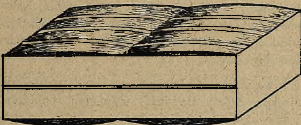
Rys. 5. Skrzynka wypełniona owocami przy sposobie pakowania naprzemianległym.
