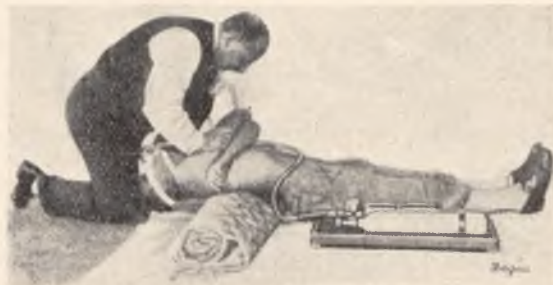
Rys. 14 — Aparat tlenowy ratowniczy Degea-Audos J. 1 przy podawaniu tlenu
