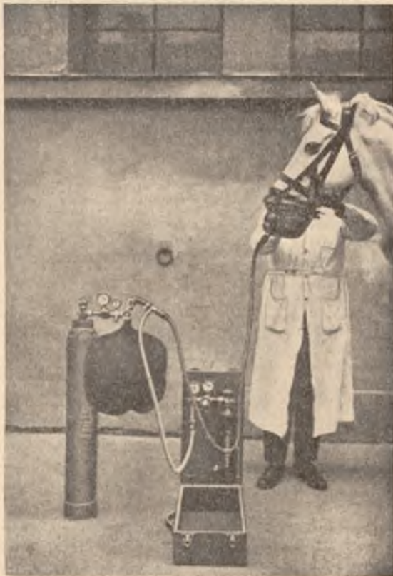
Rys. 9. — Aparat ratowniczy tlenowy Draegera dla koni, połączony z dodatkowym urządzeniem do podawania domieszki dwutlenku węgla.
