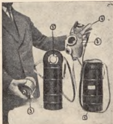
Rys. 4. — 1. puszka maski „S B A”; 2. maska właściwa; 3. pochłaniacz; 4. taśmy nagłowia; 5. pudełko z zapasowymi częściami maski.
