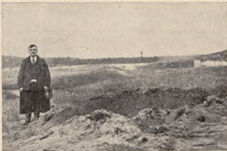
Rys. 2. — Lej po wybuchu bomby burzącej w gruncie średnio-miękkim.
