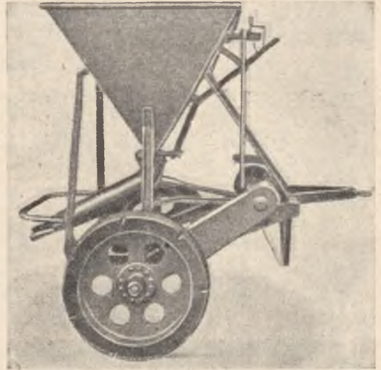
Rys. 10. — Przyczepka dwukołowa z siewnikiem rzutowym (tuleja).
