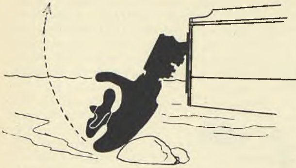
Fig. 8. Położenia śruby „Johnsona” przy najechaniu na przeszkodę.
