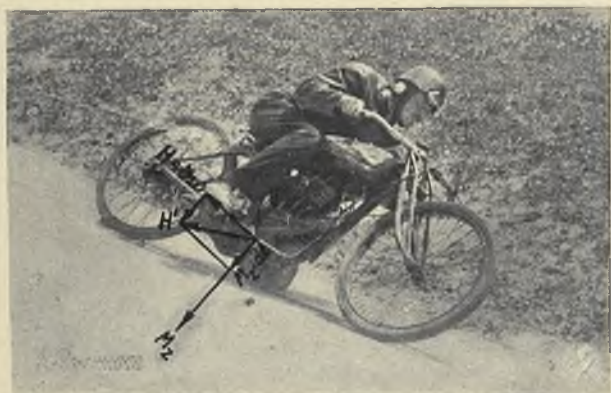
Rys. 11. Wpływ mom. M_z od zakręcania na wektor H silnika normalnego, w kierunku wywracania motocykla. Podobną reakcję dają koła biegowe.
