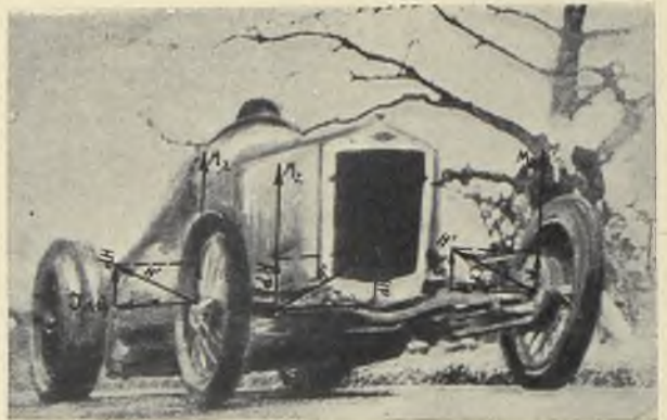
Rys. 5. Moment M_z od zakręcania w prawo, oddziałuje na wektor H silnika w kierunku unoszenia przodu, wspomagając działania unoszące przednie koło wewnętrzne.
