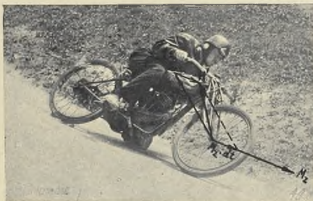
Rys. 10. Wpływ mom. M_z od pochylenia na wektor H koła, w kierunku skręcania przedniego koła ku wnętrzu krzywizny wirażu. Podobną reakcję daje koło tylne i silnik.
