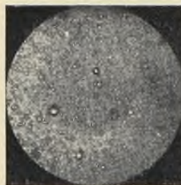
Ciśnienie wtrysku 75 at \Phi = 4,37 \mu
