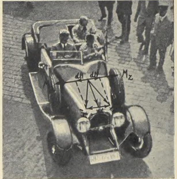
Rys. 4. Moment M_z od unoszenia (lub opadania) przodu (lub tyłu) samochodu, oddziałuje na wektor H silnika w kierunku zarzucania poprzecznego.
