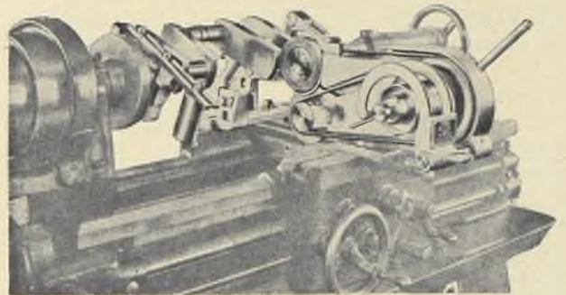
Rys. 2. Szlifierka dla małych warsztatów naprawczych do usuwania owalizacji z wałów korbowych. Owalizacja nie powinna przekraczać 1-2/100 mm.
