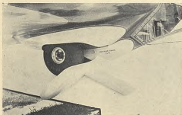
Savoia - Marchetti S-80 z siln. Colombo 130 KM. Widok ogólny oraz częściowo podniesionego podwozia.
