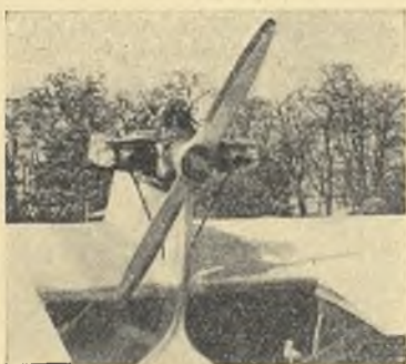
Koziół siln. na szyb. BAC.
