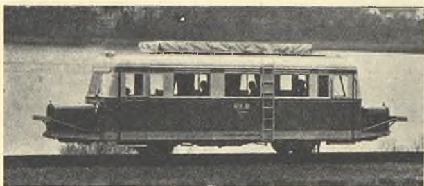
Autobus szynowy wyrobu fabryki Wismar z dwoma silnikami Forda o mocy 40 KM.
