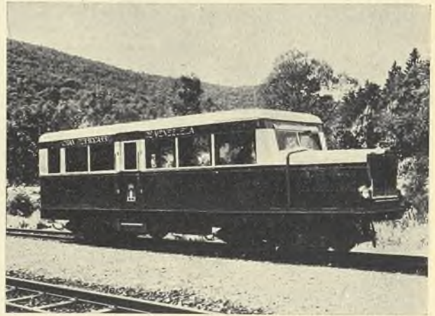
Autobus szynowy wyrobu fabryki Wismar. Silnik benzynowy marki Büssing o mocy 100 KM.
