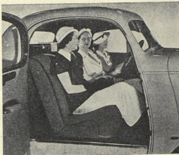
Wyzyskanie całej szerokości podwozia pozwala na zastosowanie trzymiejscowego siedzenia.
